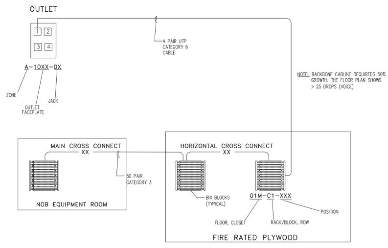
NOTE: BACKBONE CABLINE REQUIRES 50% GROWTH. THE FLOOR PLAN SHOWS > 25 DROPS (VOICE).
